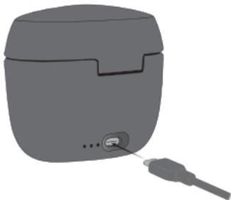
Insérez l'autre extrémité du câble USB à l'arrière du chargeur
