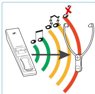
La portée de l'émetteur varie beaucoup selon les éléments de l'environnement : épaisseur des murs, matériau des murs, etc. Si le récepteur stéthoscopique quitte la portée de l'émetteur, la qualité sonore se détériore, puis la connexion est interrompue. Vous entendez des bips d'alerte dans le récepteur stéthoscopique.
