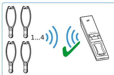
Vous pouvez simultanément utiliser jusqu'à 4 récepteurs stéthoscopiques appairés avec votre émetteur. Tous les autres récepteurs stéthoscopiques appairés et allumés ne peuvent pas se connecter à l'émetteur.
